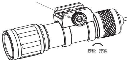
③ 按压步枪灯导轨夹，安装在选定位置，拧紧螺纹
